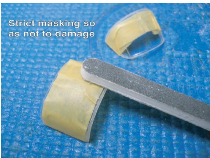
ウィンドシールドとキャノピーの削り出し Machined windshield and canopy
